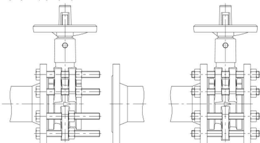
Отверстия фланцев клапанов BOA-SuperCompact® соответствуют толщине фланцев по DIN EN 1092-2 PN 16 (включая допуски) и расположены по соответствующей схеме. Они являются обычными фланцами, как например у BOA-Compact®, и пригодны для встраивания в трубопровод и для применения в качестве концевой арматуры.
